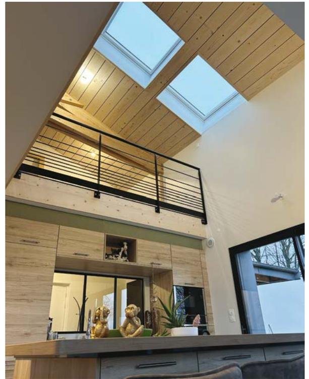
intérieur sain et confort au quotidien, ce type de fenêtre motorisée est donc idéal. La fenêtre de toit Integra peut s'ouvrir et se fermer d'une simple pression sur le clavier mural fourni, ce qui en fait un produit particulièrement adapté aux endroits difficiles d'accès.
